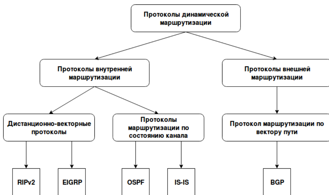
Рисунок 12.4 – Классификация протоколов динамической маршрутизации
